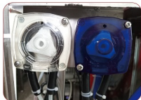
每台設備均配添加器，可精準控制用量。
